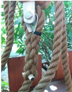
Ich habe jedoch Vorarbeit geleistet und die wichtigsten Teile, die grossen Schiffsblöcke aus Eschenholz für die Grossmast-Verstägung mehrfach imprägniert und die Achsenbolzen-Sicherungsplättchen angeschraubt. Danach habe ich mich nach Jahren (inzwischen 12) wieder einmal mit dem Spleissen von Tauwerk vertraut gemacht und mich an einem Kausch-Spleiss versucht. Diesen danach befestigt am Hundsfott des oberen Blocks. Alles wie gehabt, nessen problema!
